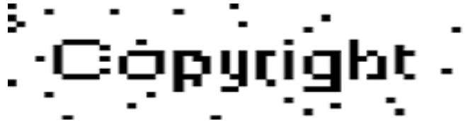
Figure 3 (D) - JPEG Compression Q=75 (k = 40)
